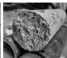
写真-4 公開された打継ぎ部のコンクリートコア
