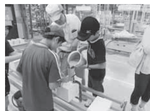
石膏型枠への原料(泥しょう)の流し込み
