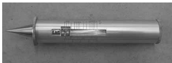
写真－2 山中式土壤硬度計
