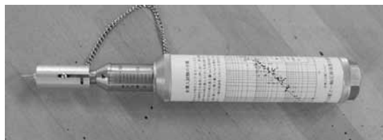
写真－1 針貫入試験器（軟岩ペネトロメーター）
