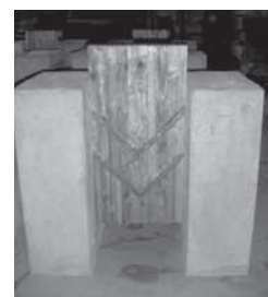
写真3：斜め鉄筋押し抜きせん断試験
