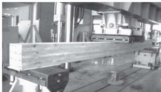
写真2：ラミナー材HPFRCC積層部材（L=3.3m）
