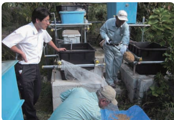
鉄バクテリア濾過装置の手作り実証試験
