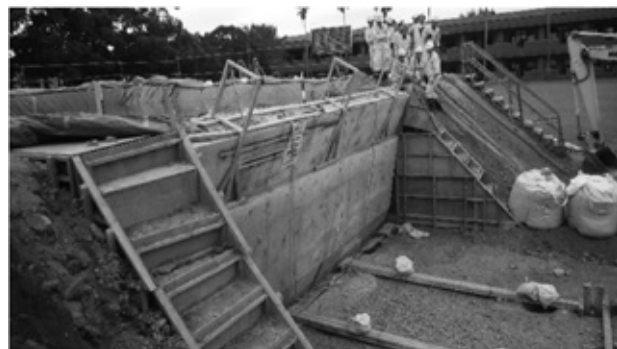
(背面水圧で転倒中のソイルダム)
