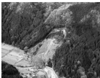
写真-1 耶馬溪町金吉の大規模崩壊 (福岡大学村上哲教授撮影)
