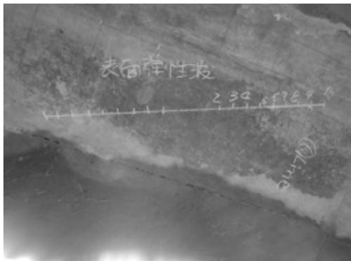
写真-2 表面弾性波速度 (未補修部)
