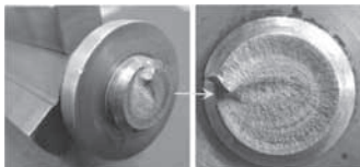
図-1 ネジの疲労破面 マクロ観察事例
