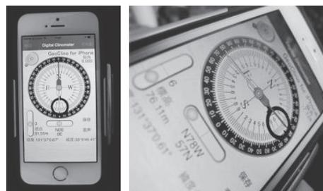
老眼に優し クリノメーターアプリ「GeoClino」と表示画面の仕様となっていました。特に、デバイスを面構造に1度当てるだけで(クリノメーターは2度)、走向傾斜が同時に計測できることに驚きました。偏角すら自動で設定され、そのまま地図画面に保存すればルートマップも並行して出来ます。
